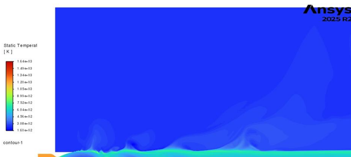
Rysunek 6. Rozkład temperatury statycznej w dyszy na wysokości lotu 5 km
