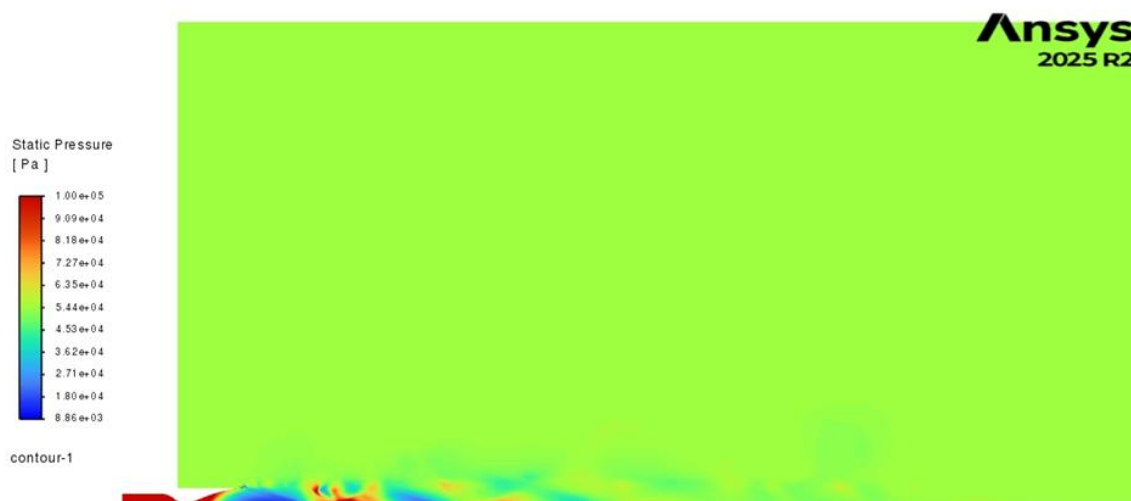
Rysunek 5. Rozkład ciśnienia statycznego w dyszy na wysokości lotu 5 km
