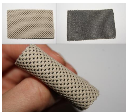
Rysunek 12. Materiał Hyperion z dwóch stron oraz zgięty po badaniu odporności na wielokrotne zginanie
