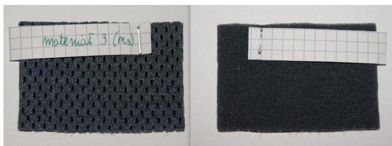
Rysunek 3. Dwie strony materiału na nośniku dzianinowym, z powłoką PU
