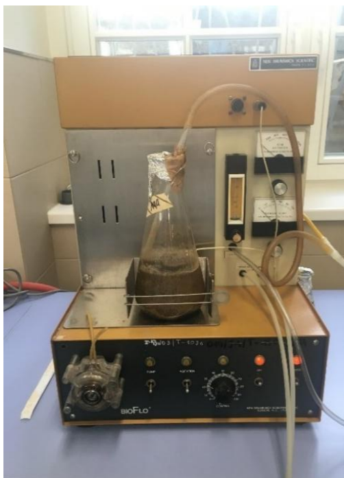
Rycina 2 Osad czynny umieszczony w urządzeniu do napowietrzania BioFlor firmy New Brunswick Scientific, USA
