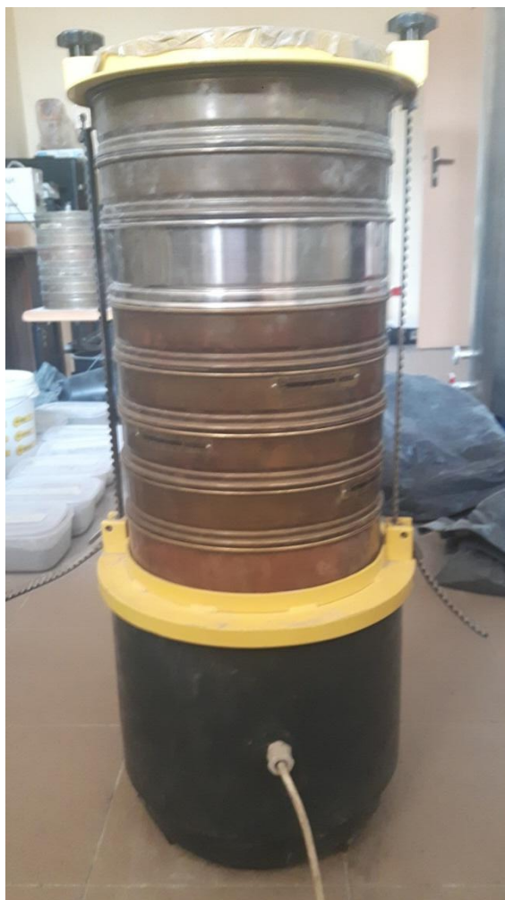
Rysunek 3. Komplet sit kontrolnych zamocowanych na przesiewaczu wibracyjnym LAB-06-300
