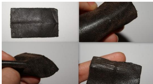
Rysunek 10. Angola Stretch, baza Lycra z obu stron oraz zgięty po badaniu odporności wielokrotne zginanie
