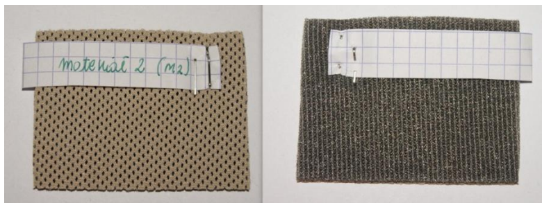
Rysunek 2. Dwie strony Hypperionu – dzianiny syntetycznej z pianką PU, laminowanej
