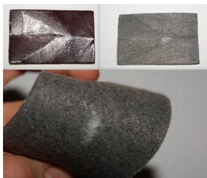
Rysunek 11. Tworzywo skóropodobne koagulacyjne, na nośniku włókninowym, z obu stron oraz zgięty po badaniu wytrzymałości na wielokrotne zginanie
