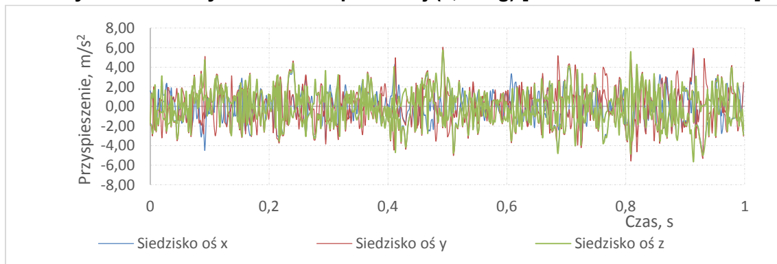
Rys. 8. Przebiegi czasowe przyspieszeń zarejestrowanych na siedzisku fotela kierowcy w samochodzie Opel Astra, podczas jazdy samochodu z prędkością 120km/h i z niewyrównoważonym kołem osi przedniej (0,12 kg) [Źródło: Badania własne].
