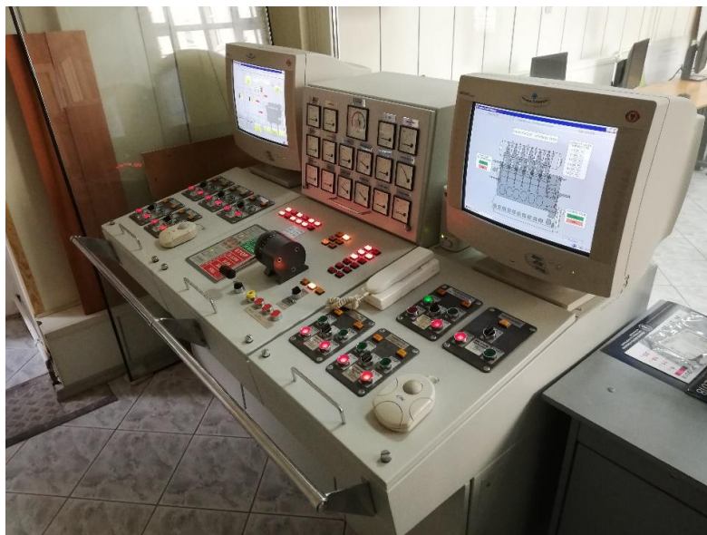
Rys.2. Symulator silnika wolnoobrotowego, źródło: opracowanie własne na podstawie [6]
