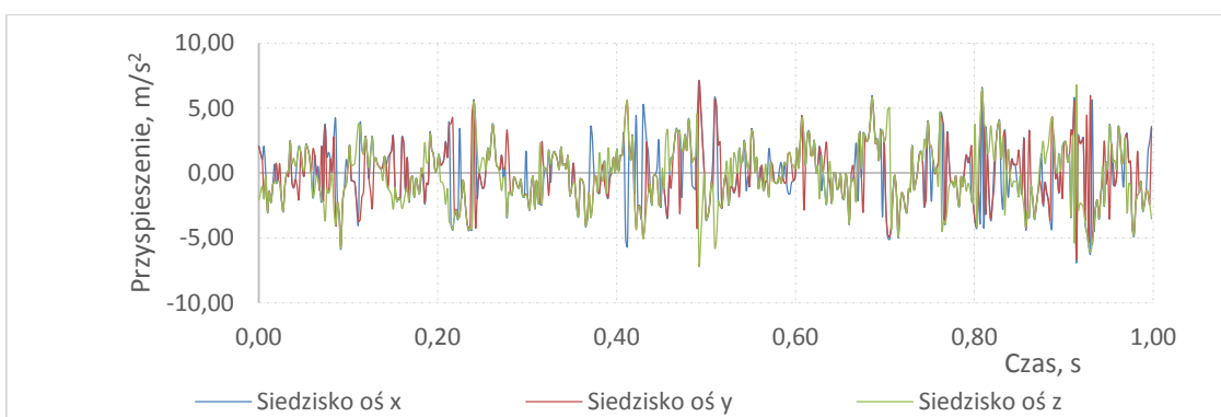
Rys. 4. Przebiegi czasowe przyspieszeń zarejestrowanych na siedzisku fotela kierowcy w samochodzie Ford Focus, podczas jazdy samochodu z prędkością 120km/h i z niewyrównoważonym kołem osi przedniej (0,12 kg) [Źródło: Badania własne].
