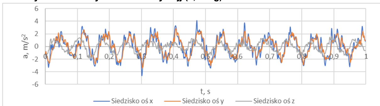
Rys. 5. Przebiegi czasowe przyspieszeń zarejestrowanych na siedzisku fotela kierowcy w samochodzie Ford Focus, podczas jazdy samochodu z prędkością 120km/h i z niewyrównoważonym kołem osi tylnej (0,12 kg)
