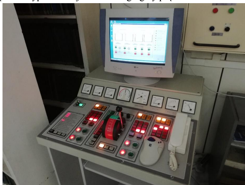
Rys.3. Symulator silnika średnioobrotowego, źródło: opracowanie własne na podstawie [6]
