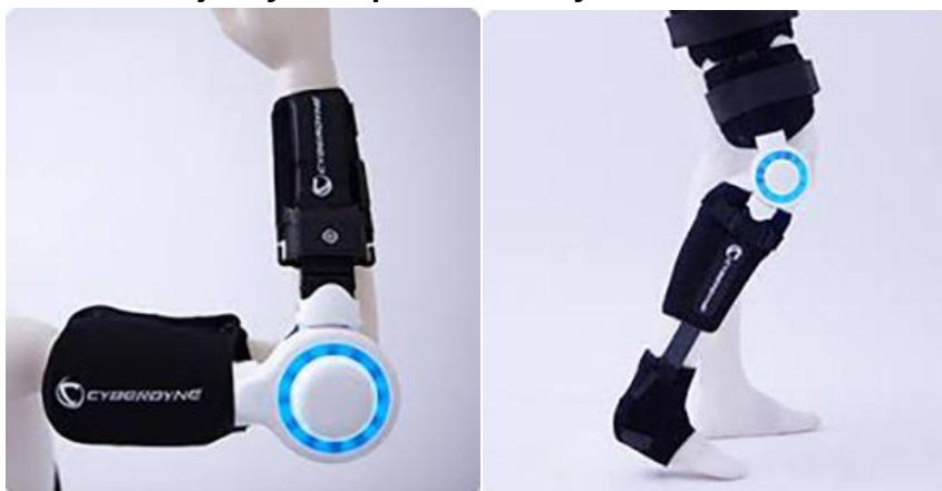
Rys. 8. Egzoszkielet HAL o jednym stopniu swobody
