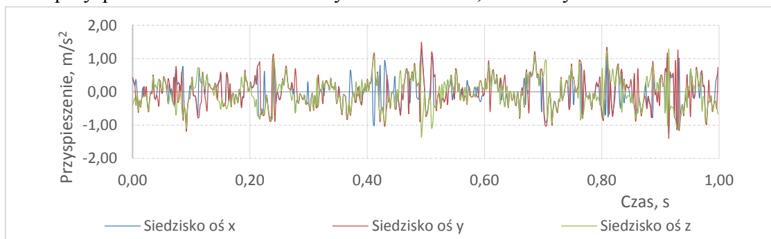
Rys. 2. Przebiegi czasowe przyspieszeń zarejestrowanych na siedzisku fotela kierowcy w samochodzie Ford Focus, podczas jazdy samochodu z prędkością 60km/h i z niewyrównoważonym kołem osi przedniej (0,06 kg) [Źródło: Badania własne].
