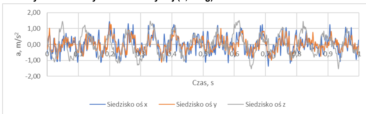
Rys. 7. Przebiegi czasowe przyspieszeń zarejestrowanych na siedzisku fotela kierowcy w samochodzie Opel Astra, podczas jazdy samochodu z prędkością 60km/h i z niewyrównoważonym kołem osi tylnej (0,06 kg)
