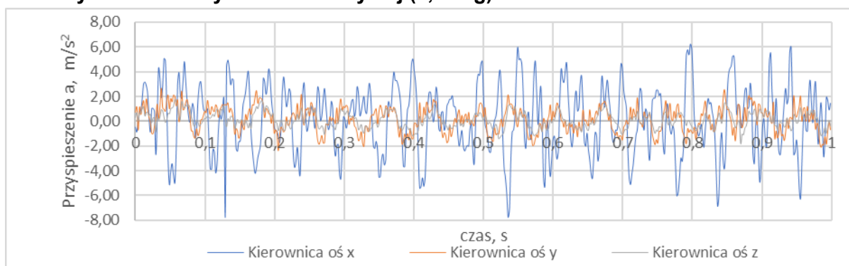
Rys. 10. Przebiegi czasowe przyspieszeń zarejestrowanych na kole kierownicy w samochodzie Opel Astra, podczas jazdy samochodu z prędkością 120km/h i z niewyrównoważonym kołem osi tylnej (0,12 kg)
