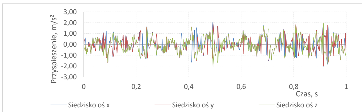
Rys. 10. Przebiegi czasowe przyspieszeń zarejestrowanych na siedzisku fotela kierowcy w samochodzie Peugeot 301, podczas jazdy samochodu z prędkością 60km/h i z niewyrównoważonym kołem osi przedniej (0,06 kg) [Źródło: Badania własne].
