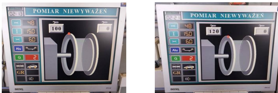
Rys.2. Uzyskane niewyrównoważenie kół samochodowych na wyważarce TROLL -2251
