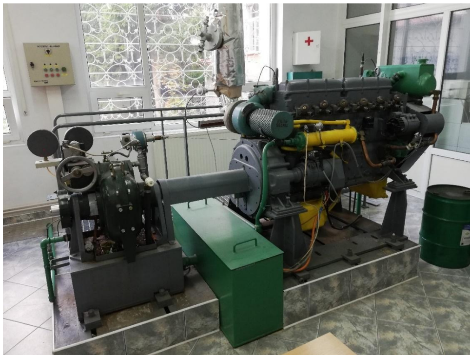
Rys.5. Stanowisko badawcze silnika MORS SW680, źródło: opracowanie własne na podstawie [7]
