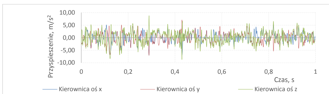
Rys. 13. Przebiegi czasowe przyspieszeń zarejestrowanych na kole kierownicy w samochodzie Peugeot 301, podczas jazdy samochodu z prędkością 120km/h i z niewyrównoważonym kołem osi przedniej (0,12 kg) [Źródło: Badania własne].
