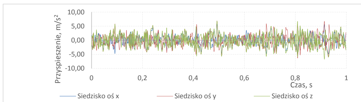
Rys. 12. Przebiegi czasowe przyspieszeń zarejestrowanych na siedzisku fotela kierowcy w samochodzie Peugeot 301, podczas jazdy samochodu z prędkością 120km/h i z niewyrównoważonym kołem osi przedniej (0,12 kg) [Źródło: Badania własne].
