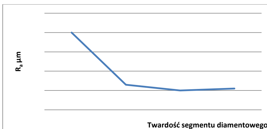
Rys. 4. Ogólna zależność w kształtowaniu chropowatości powierzchni od twardości segmentu diamentowego
