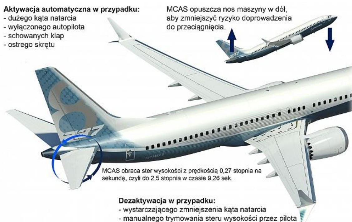
Rysunek 7. Sposób działania MCAS w Boeingu 737 MAX 8
