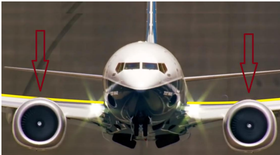
Rysunek 5. Umieszczenie silnika CFM LEAP-1A pod skrzydłem Boeinga 737 MAX 8
