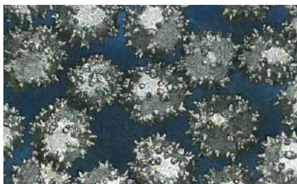
Rysunek 5. Niklowane ziarna diamentowe z tak zwanymi kolcami do narzędzi o spoiwach żywicznych
